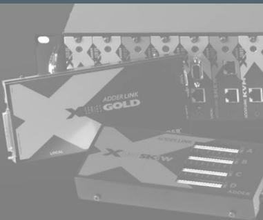
Die X-Serie X-KVM-Einheiten wurden speziell für die komfortable, abgesetzte Steuerung von PCs oder KVM-Switches über 200 m lange UTP-/STP-Kabel entwickelt und eignen sich ideal für den Einsatz in Banken, Datenzentren und anderen Umgebungen mit hoher Packungsdichte, bei denen es auf eine optimale Platzausnutzung ankommt.
