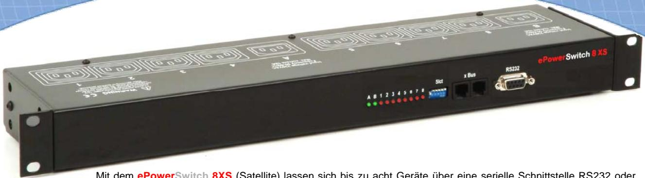
Mit dem **ePowerSwitch 8XS** (Satellite) lassen sich bis zu acht Geräte über eine serielle Schnittstelle RS232 oder RS485 ein- und ausschalten. Durch den Anschluss von bis zu 16 Satelliten lässt sich das System zur Ansteuerung von bis zu 128 Steckdosen erweitern.
