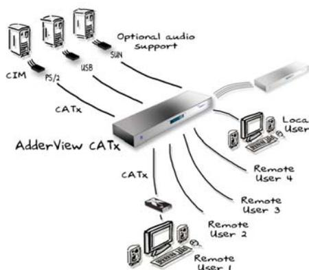
Die beiden Modelle dieser Serie sind der AdderView CATx mit 16 oder 24 CATx Computeranschlüssen, 4 Simultanbenutzern (1x lokal PS/2 oder USB, 4 x dezentral über CATx) und der AdderView CATx IP mit 16 oder 24 CATx Computeranschlüssen, 4 Simultanbenutzern (1x lokal PS/2 oder USB, 2 x dezentral über CATx, 1 x global über IP).
