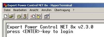
Jetzt können die Power Ports per Zahlentasten ein- und ausgeschaltet werden. Mit der c-Taste werden Ihnen die Netzwerkeinstellungen angezeigt und mit der Esc-Taste können Sie sich ausloggen.
