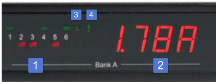
1. 6 Klartextanzeigen (on/off) für den Zustand der Ausgänge (Bank A oder B)
